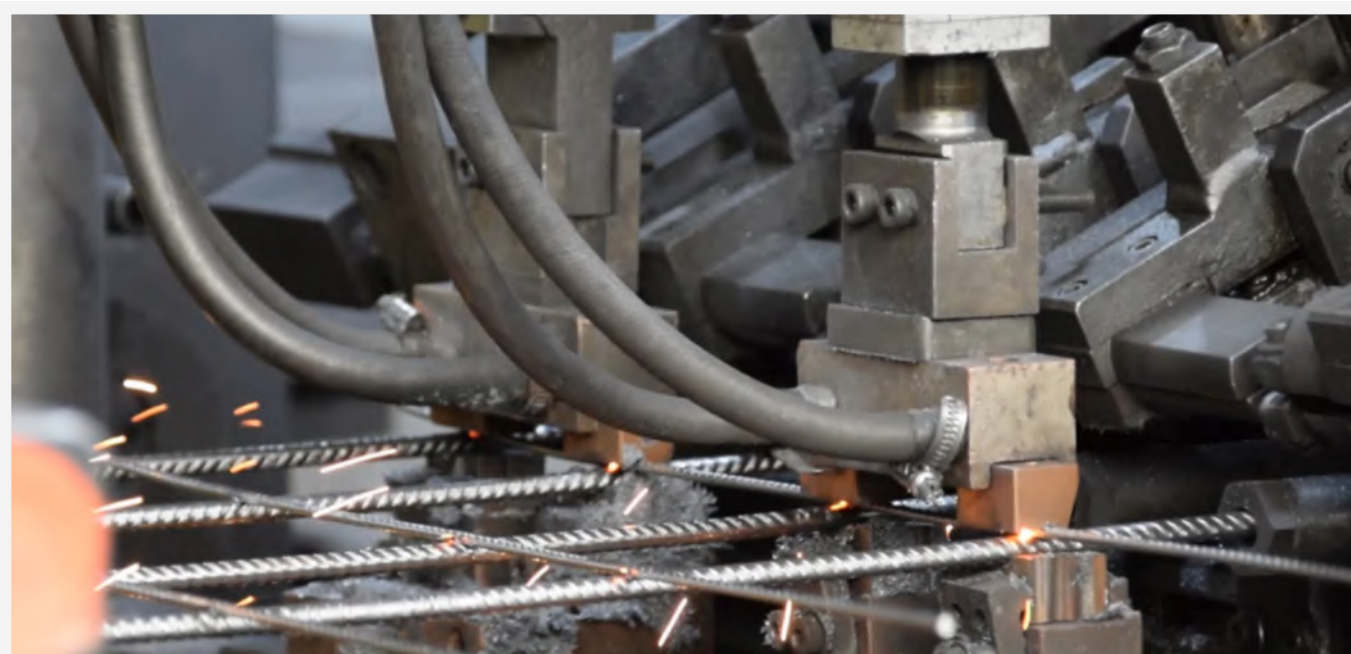
Figura 1. Instalaciones para el preensamble mediante electrosoldadura.
